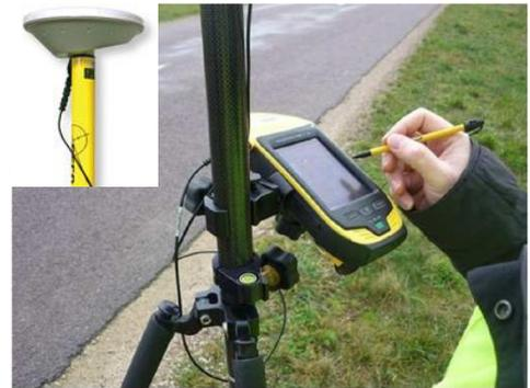
Figure 2 : Matériel utilisé pour le repérage GPS
